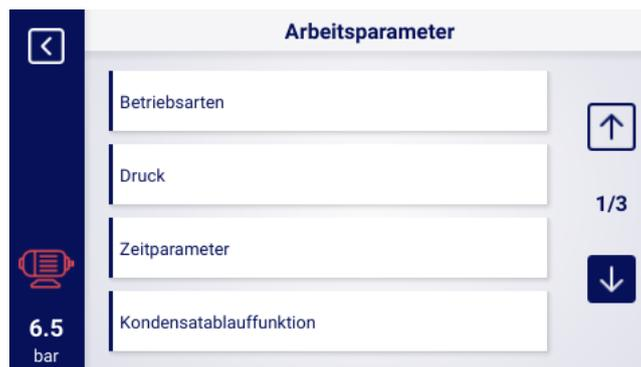
Abbildung 12: Kacheln mit Parameter-Untergruppen am Beispiel der Betriebsparameter
