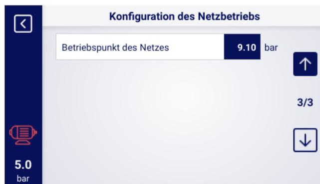
Abbildung 45: Konfigurationsmenü für den Netzbetrieb 3/3
