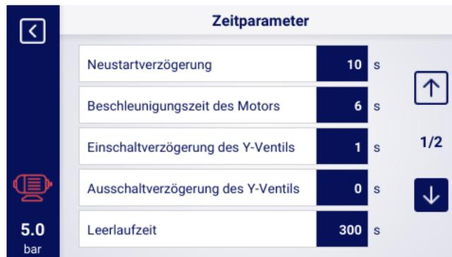
Abbildung 27: Menüansicht mit Zeitparametereinstellungen für die Umrichterkonfiguration
