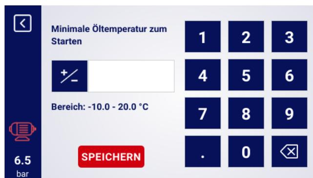
Abbildung 14: Bildschirmtastatur am Beispiel der minimalen Öltemperatur zum Starten
