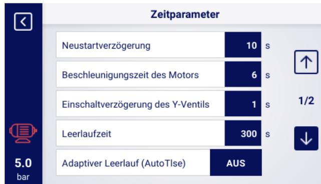
Abbildung 30: Ansicht des Menüs mit den Zeitparametereinstellungen für die Direktstartkonfiguration
