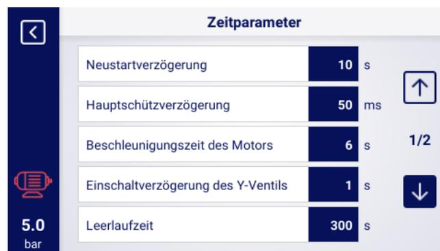
Abbildung 25: Ansicht des Menüs mit den Einstellungen der Zeitparameter für die Stern-Dreieck-Konfiguration
