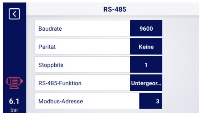
Abbildung 48: Menü zur Konfiguration des RS-485-Anschlusses
