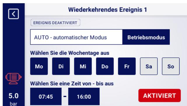
Abbildung 40: Beispiel für die Konfiguration eines zyklischen Ereignisses
