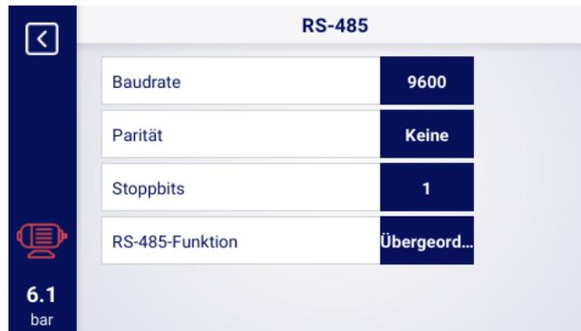
Abbildung 42: Menü zur Konfiguration des RS-485-Anschlusses
