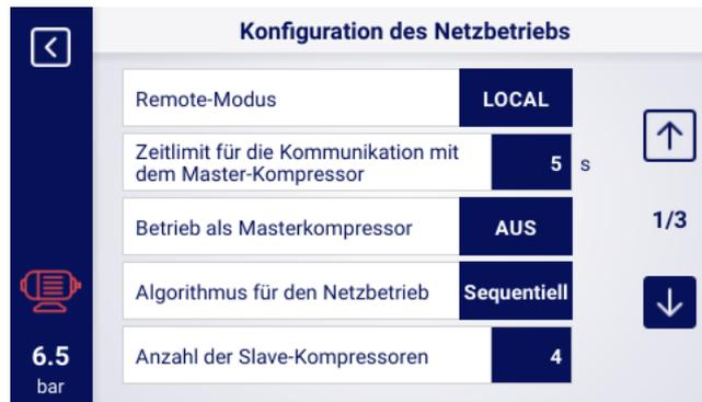
Abbildung 43: Konfigurationsmenü für den Netzbetrieb 1/3
