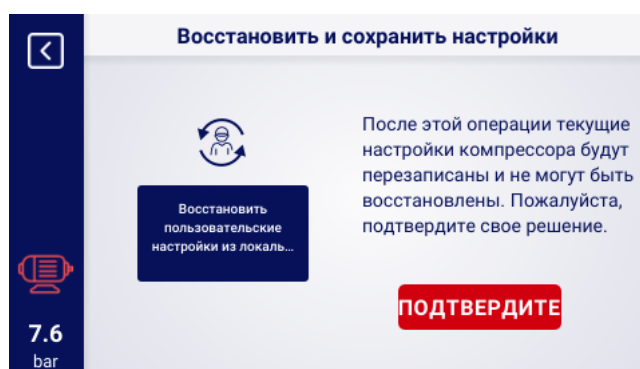
Рис. 34: Предупреждение о перезаписи пользовательских настроек
