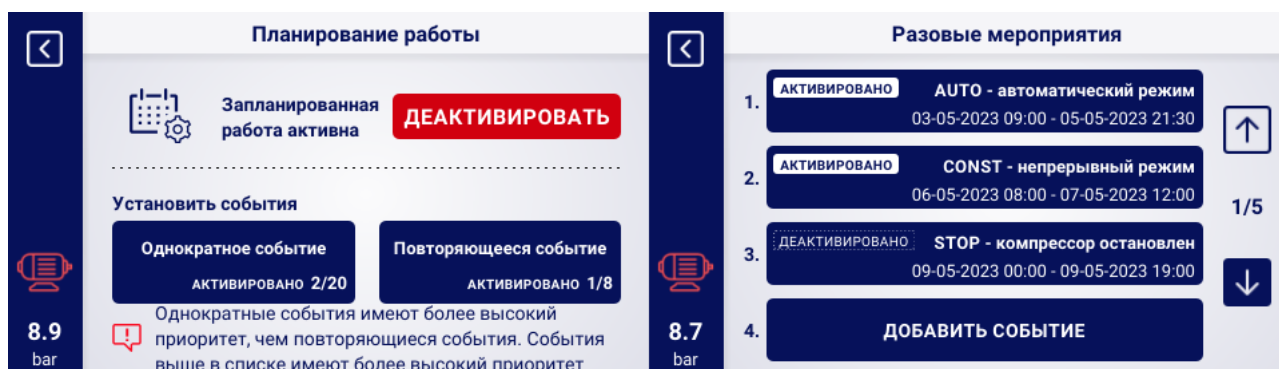
Рис. 40: Вкладка "Планирование работы" и примерный список событий
