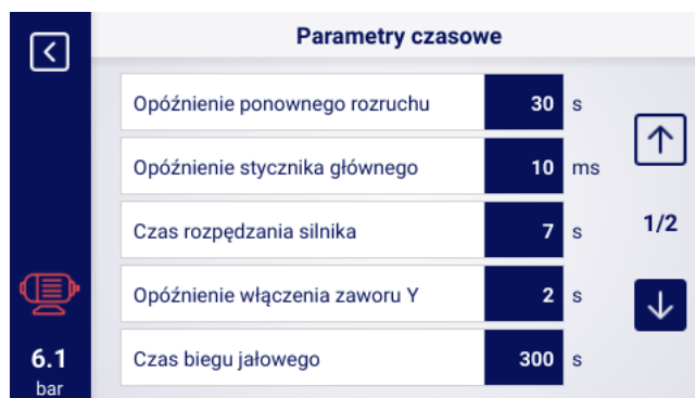
Рис. 27: Вид меню с настройками временных параметров для конфигурации Звезда-треугольник
