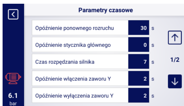
Рис. 29: Вид меню с настройками временных параметров для конфигурации преобразователя частоты
