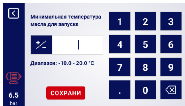
Рис. 15: Экранная клавиатура на примере минимальной температуры масла для старта
