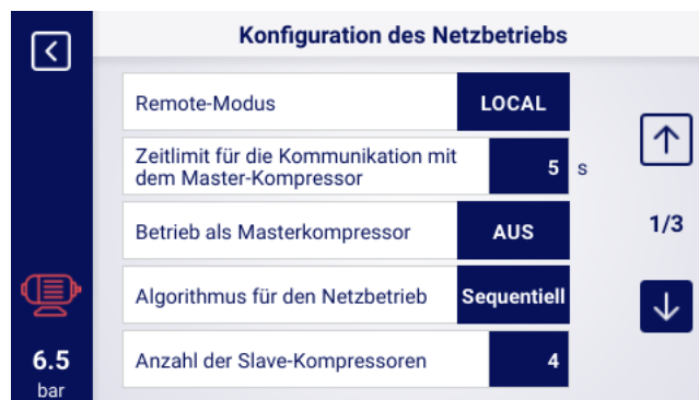
Abbildung 14: Parameterkacheln mit einem Beispiel für eine Untergruppe der Konfigurationsparameter für den Netzbetrieb
