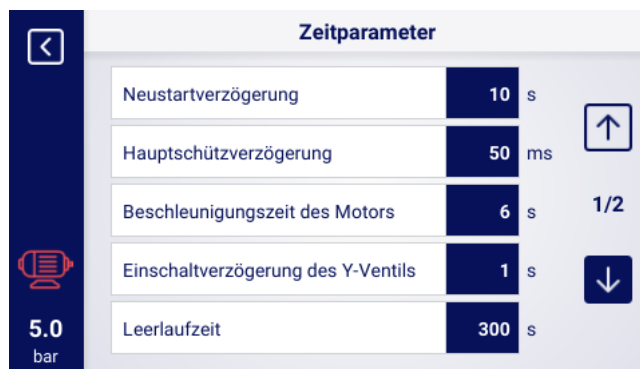
Abbildung 26: Ansicht des Menüs mit den Einstellungen der Zeitparameter für die Stern-Dreieck-Konfiguration
