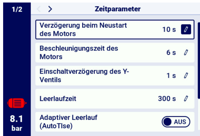
Abbildung 30: Ansicht des Menüs mit den Zeitparametereinstellungen für die Direktstartkonfiguration
