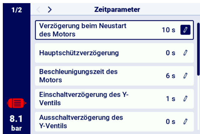
Abbildung 27: Menüansicht mit Zeitparametereinstellungen für die Umrichterkonfiguration
