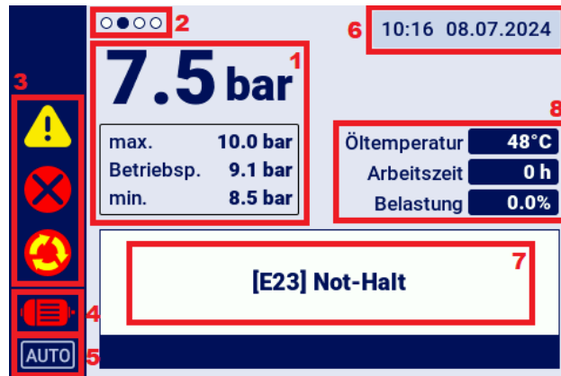
Abbildung 4: Hauptansicht in Abschnitte unterteilt
