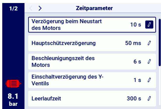
Abbildung 25: Ansicht des Menüs mit den Einstellungen der Zeitparameter für die Stern-Dreieck-Konfiguration
