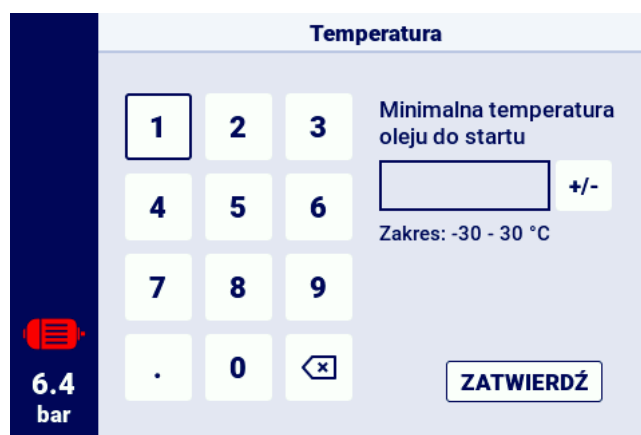
Rysunek 13: Klawiatura ekranowa na przykładzie minimalnej temperatury oleju do startu
