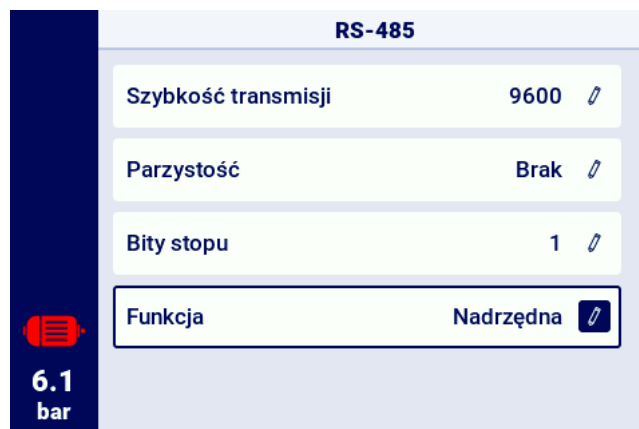
Rysunek 39: Menu konfiguracji portu RS-485
