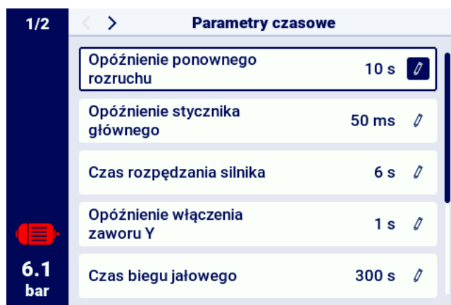
Rysunek 25: Widok menu z ustawieniami parametrów czasowych dla konfiguracji Gwiazda-trójkąt
