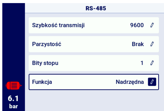
Rysunek 45: Menu konfiguracji portu RS-485
