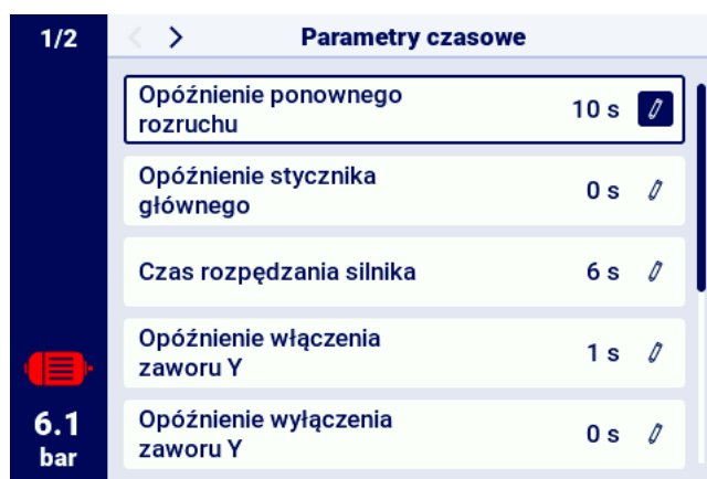
Rysunek 27: Widok menu z ustawieniami parametrów czasowych dla konfiguracji Falownik
