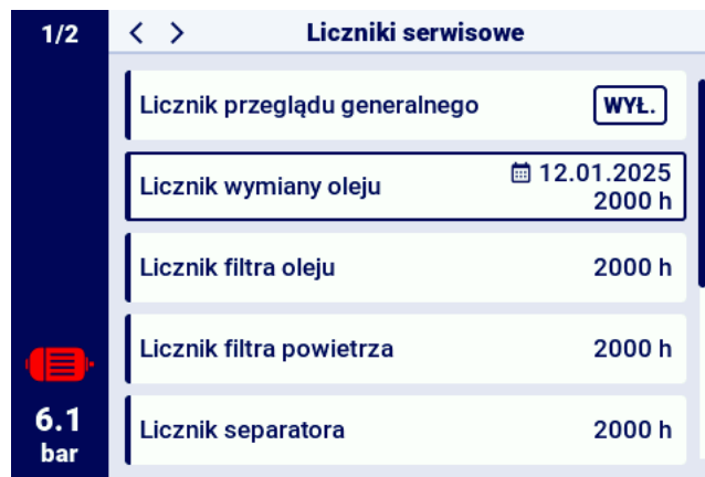
Rysunek 33: Zakładka "Liczniki serwisowe"
