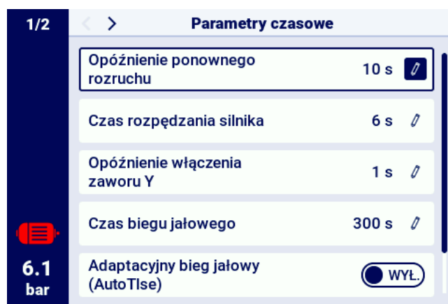
Rysunek 30: Widok menu z ustawieniami parametrów czasowych dla konfiguracji Rozruch Bezpośredni
