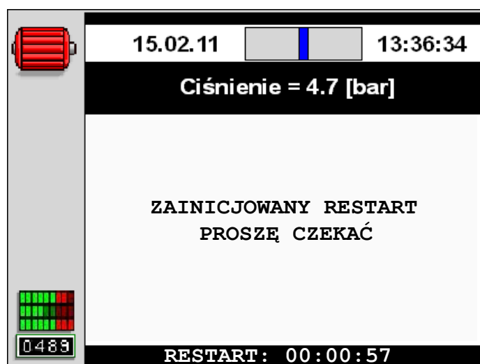
Rysunek 14: Widok ekranu MS-887VFD z zainicjowaną funkcją restartu
