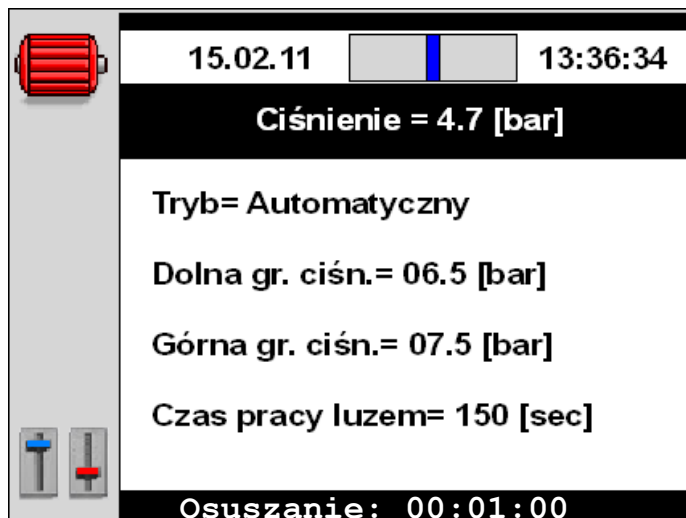
Rysunek 13: Widok ekranu MS-887VFD z włączoną funkcją osuszacza
