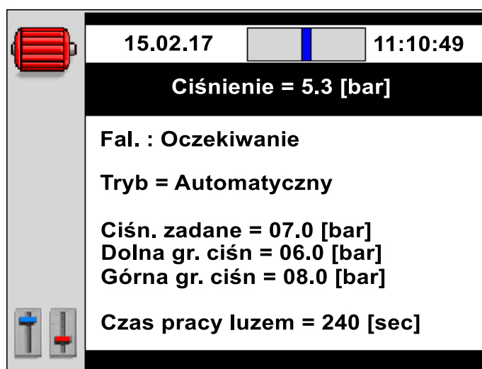
Rysunek 7: Widok menu pracy z falownikiem
