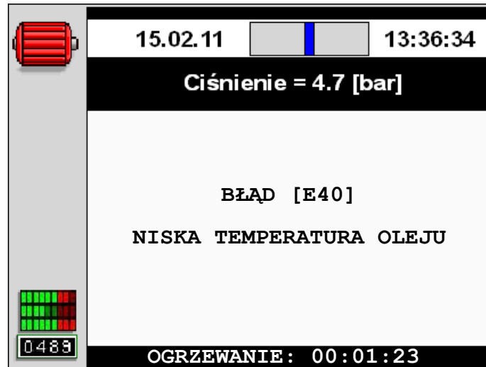
Rysunek 12: Widok ekranu MS-887VFD z włączoną funkcją ogrzewania
