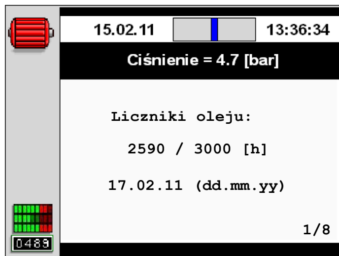
Rysunek 3: Widok ekranu licznika oleju MS-887VFD
