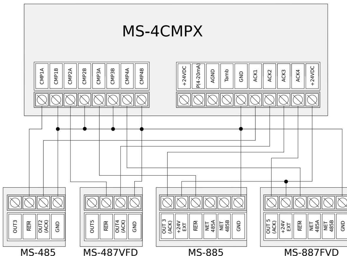
Figure 6: Schemat podłączenia sterownika
