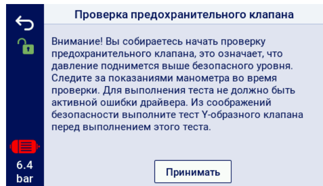
Рис. 32: Предупреждение о начале проверки предохранительного клапана
