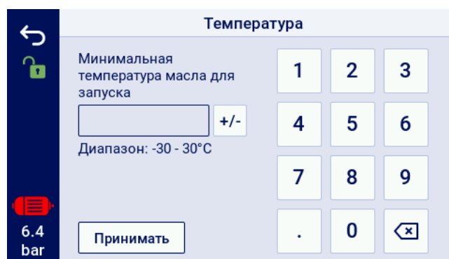
Рис. 13: Экранная клавиатура для примера минимальной температуры масла для запуска
