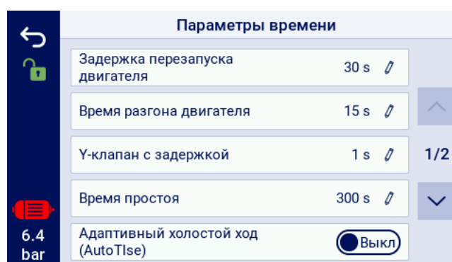
Рис. 30: Вид меню с настройками временных параметров для конфигурации Прямой запуск
